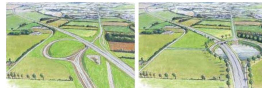
Dessin du contournement d'agglomération, déviation de Villers-Bocage par l'A84 / À gauche, option pour une voie autoroutière doublant une route nationale, échangeur peu lisible créant d'importants délaissés. À droite, proposition d'une alternative de doublement de l'ancienne route, avec entrée de déviation clairement marquée et transformable en giratoire dénivelé. (c) P.M. Tricaud, Laurif
