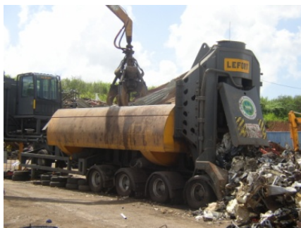
Figure 43 : Photos illustrant : 1. la mise en fonctionnement de la cisailluse avec un mélange de GEM HF dépollué et de ferrailles – 2. un ballot constitué de GEM HF dépollués et de ferrailles (Source : CARAIBES ENVIRONNEMENT)
