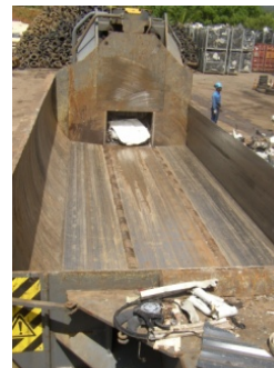
Figure 43 : Photos illustrant : 1. la mise en fonctionnement de la cisailluse avec un mélange de GEM HF dépollué et de ferrailles – 2. un ballot constitué de GEM HF dépollués et de ferrailles (Source : CARAIBES ENVIRONNEMENT)
