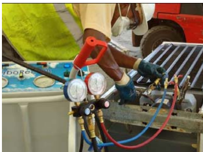
Figure 44 : Photos illustrant : 1. le pompage des gaz – 2. vidange manuelle d'un compresseur – 3. compresseurs stockés dans des bacs (Source : AER et CARAIBES ENVIRONNEMENT)
