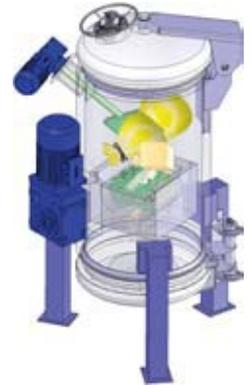
**3. Le Chauffage** s'effectue par admission de vapeur saturée faisant monter la température à 138°C et la pression à 3.8 bars.
