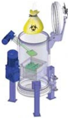
**1. Le Chargement** automatique se fait par l'ouverture supérieure de la machine.
