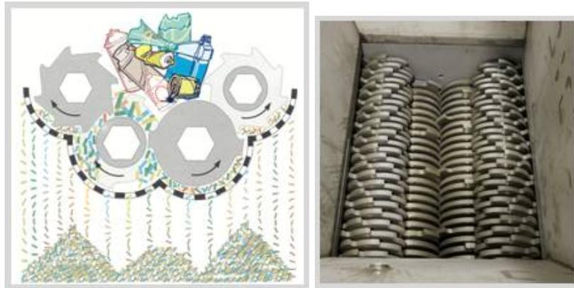
Figure 15 : Broyeur à 4 axes (Source : site internet ECOSTERYL)
