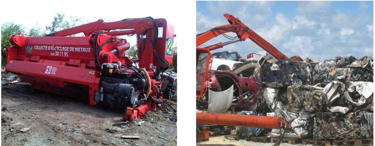
*Figure 31 : Photos illustrant l'unité mobile de compactage des VHU de la SNR
