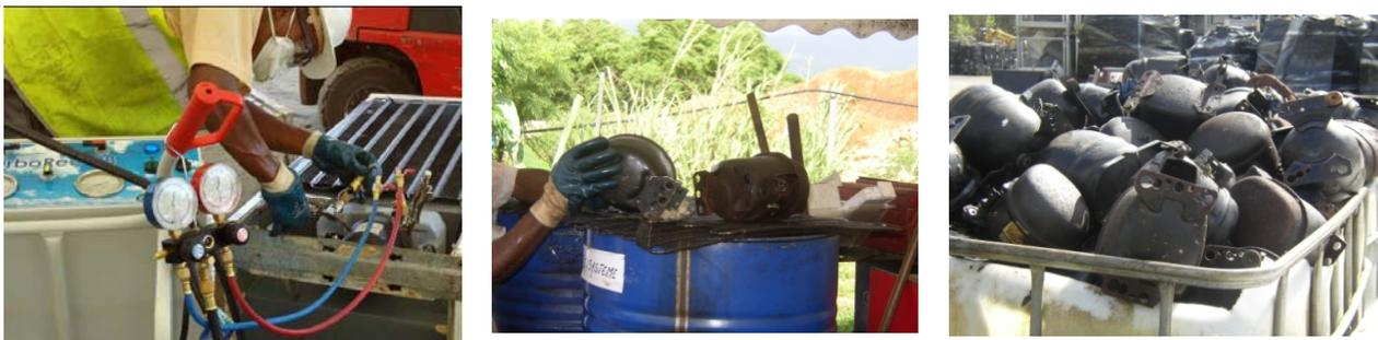
Figure 46 : Photos illustrant : 1. le pompage des gaz – 2. vidange manuelle d'un compresseur – 3. compresseurs stockés dans des bacs (Source : AER et CARAIBES ENVIRONNEMENT)
