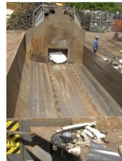
Figure 45 : Photos illustrant : 1. la mise en fonctionnement de la cisailleuse avec un mélange de GEM HF dépollué et de ferrailles – 2. un ballot constitué de GEM HF dépollués et de ferrailles (Source : CARAIBES ENVIRONNEMENT)
