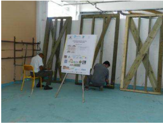
Préparation des essais et réception des panneaux de contreventement fabriqués - jeudi 17 janvier 2013
