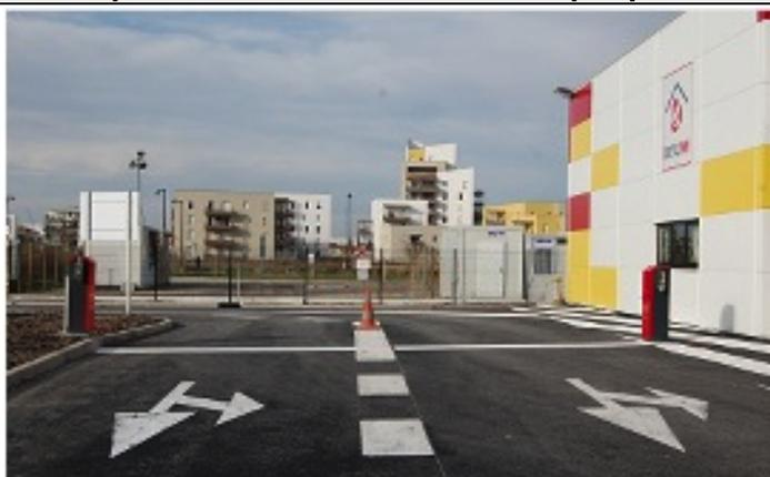
2 voies de circulation réservées aux véhicules des usagers. Un dispositif de reconnaissance des plaques d'immatriculation permet d'identifier les usagers et de contrôler l'ouverture de la barrière automatique.
