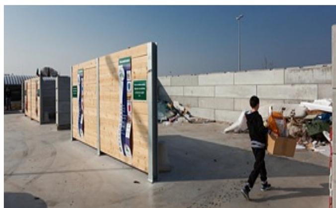
2 casiers de 80 m<sup>3</sup> pour les déchets verts et les encombrants + 2 casiers de 40 m<sup>3</sup> pour les ferrailles et le bois. Des panneaux bois sont installés devant les casiers permettant d'apposer la signalétique et de limiter la prise au vent. Les remorques peuvent pénétrer dans les casiers.
