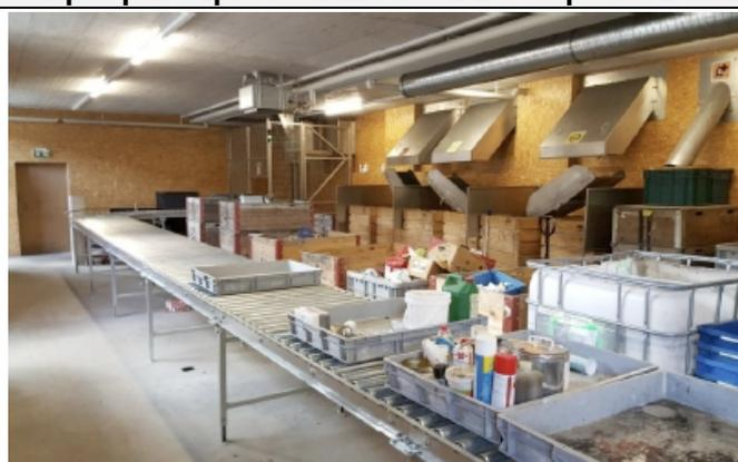
Les usagers déposent les déchets dangereux et les DEEE (petits formats) dans des bacs sur le haut de quai, qui sont ensuite descendus dans le local de conditionnement grâce à un ascenseur (situé derrière une trappe coulissante). L'agent trie progressivement les bacs et stocke les déchets par catégorie dans des contenants adaptés (caisses en plastique étanches pour les déchets dangereux).
