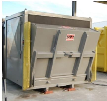
Compacteur sécurisé monobloc avec seuil de chargement bas (1m, conforme à la norme EN-ISO 13 857), indicateur de niveau et trémie intégrée et basculante de 2,5 m<sup>3</sup> refermée lors de la fermeture du site pour éviter les vols. Coût d'un compacteur : 40 k€ HT.
